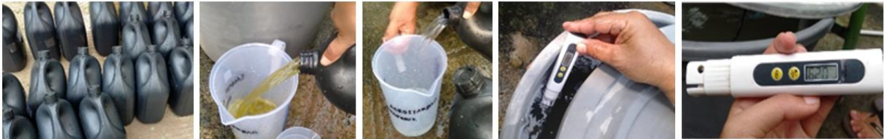
Gambar 4. Pengecekan PPM larutan nutrisi A dan B pada ember instalasi menggunakan TDS
