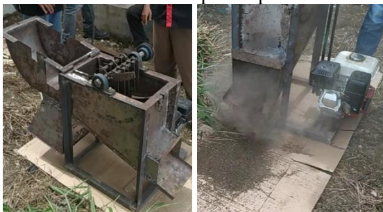
Gambar 5. Proses pengujian mesin penghancur kotoran ternak
