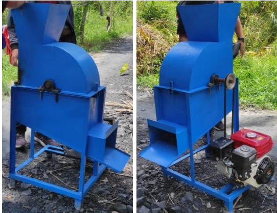
Gambar 4. Hasil akhir mesin penghancur kotoran ternak
