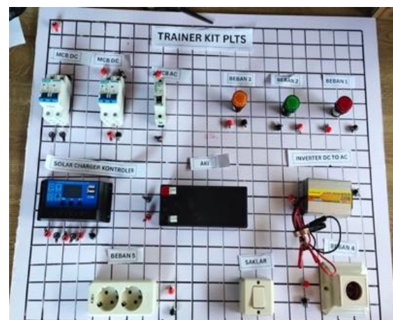
Gambar 1. Perancangan kerangka komponen Trainer Kit
