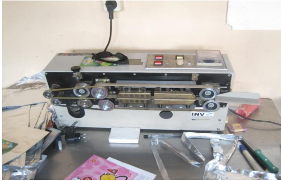
Gambar 4. Alat Pengemas Kripik Buah Apel
