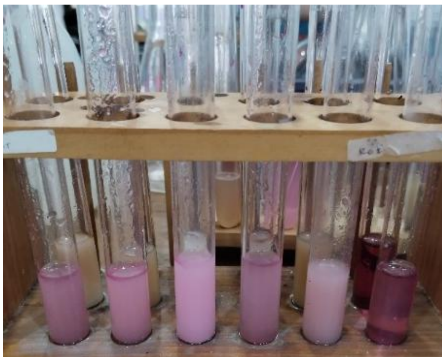
Gambar 2. Hasil identifikasi formalin pada sampel ikan asin, bakso ikan, dan ikan asap dengan larutan ekstrak kulit buah naga
