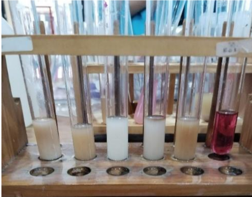
Gambar 1. Hasil uji formalin pada sampel ikan asin, bakso ikan, dan ikan asap dengan larutan KMnO_4
